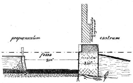
Abb. 11. Querschnitt durch Castrum-Mauer und Graben.
