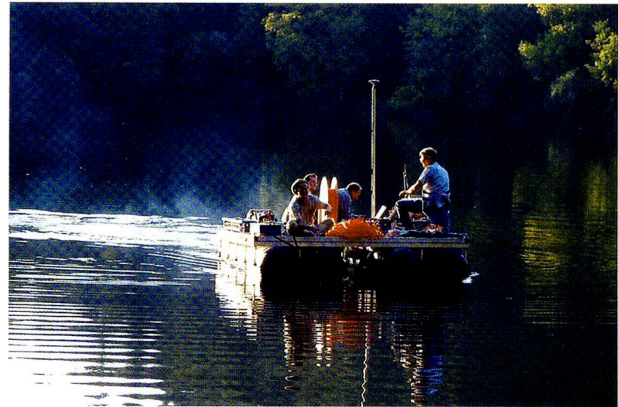
Abb. 8: Links: Entnahme von Sedimenten mithilfe von Bohrungen im Gebiet des trockengelegten Seewener Sees (Seewen/SO). Rechts: Seismische Messungen zur Kartierung der Sedimentablagerungen im Bergsee (Bad Sädingen/D).
