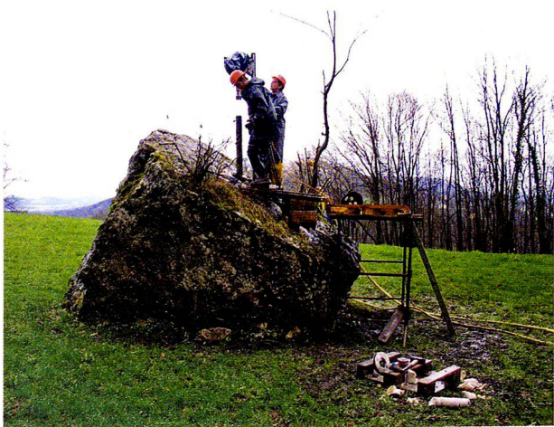
Abb. 9: Datierung des Felssturzes durch Datierung der Ablagerungen unter dem Felsbrocken. Dazu muss das Gestein durchbohrt werden.
