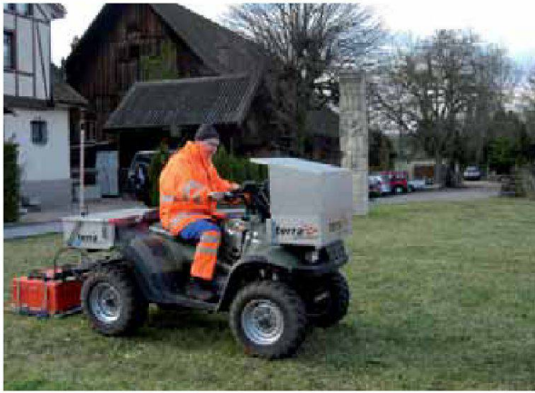
Abb. 39: Augst, Augusta Raurica. Der mit Hightech vollgepackte Kleintraktor der Firma Tena-Vermessungen aus Zürich wird in der geophysikalischen Prospektion von archäologischen Fundstätten eingesetzt. Das computerunterstützte Gefährt registriert seine Position laufend automatisch und kann sowohl Georadar-, Geoelektrik- wie auch Geomagnetikmessungen durchführen. Auf der «Rossweid» in der Augster Insula 10 wurden so viele Details der römischen Bebauungsstruktur ermittelt (2006.104).
