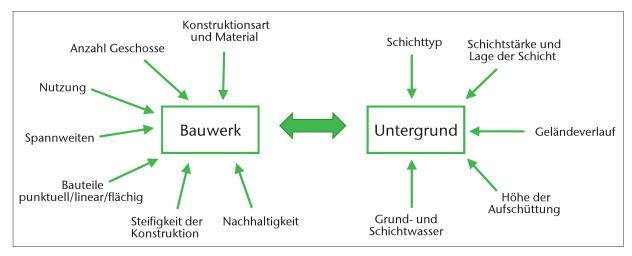
Abb. 4: Einflüsse Untergrund-Bauwerk-Interaktion.
