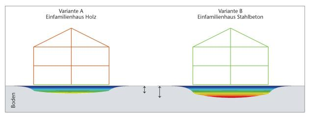
Abb. 5: Vergleich Holz – Stahlbeton, überhöhte Darstellung der Setzungen im Schnitt. Beim Vergleich der beiden Einfamilienhäuser mit unterschiedlichen Gewichten lässt sich gut erkennen, dass die Setzungen des Holzhauses (Variante A) kleiner sind als jene des Stahlbetonhauses (Variante B). Die Setzungsmulden sind überhöht dargestellt.
