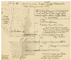
Abb. 26: Augst BL, Curia (Intervention 1906.060). Baubefundsituation von Abb. 24 und 25; in der 1906 von Theophil Burckhardt-Biedermann angefertigten isometrischen Skizze ist die Mauerfuge an der nördlichen Forumsecke (b-b1-b2-a) gut erkennbar.
