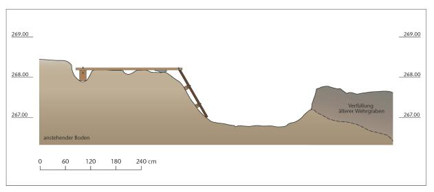
Abb. 62: Kaiseraugst AG, Gasthof zur Sonne (Grabung 2020.010). Idealprofil durch eine mögliche Rekonstruktion der hölzernen Böschungsbefestigung des jüngeren Wehrgrabens. M. 1:60.
