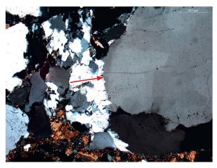
Abb. 3: Augusta Raurica. Mikrofoto (Dünnschliff) des grobkörnigen Buntsandsteins, der aufgrund der verwachsenen Quarzkörner (Pfeil) sehr verwitterungsbeständig ist. Sandsteinfragment ohne Inschrift aus einer Bauschicht des 3. Theaters von Augusta Raurica (Grabung 1995.055, Probe P88 1.1). Aufnahme mit gekreuzten Polarisationsfiltern (XPL).
