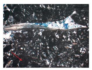
Abb. 17: Augusta Raurica. Mikrofoto (Dünnschliff) des Kimmeridge-Kalks von Solothurn («Solothurner Marmor», sog. Schalenbank) mit der Inschrift 87. Dichter Kalkstein mit grauen, gerundeten Kalkkörnern (pellets, Pfeil) und in der Bildmitte einem länglichen Fossilfragment, umgeben von einer kalzitischen Matrix (weiss, blau). Aufnahme mit gekreuzten Polarisationsfiltern (XPL).
