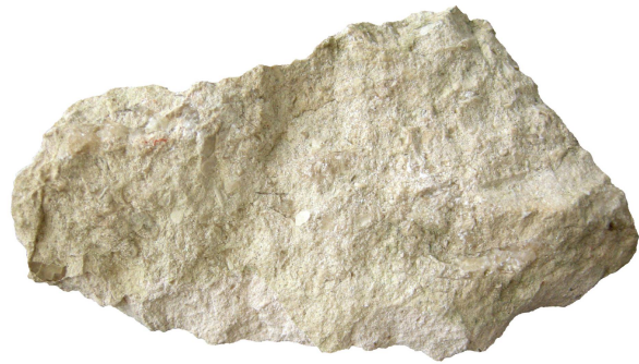
Abb. 14: Dittingen BL, Flur Rittenberghollen. Kreidiger Korallenkalk der St.-Ursanne-Formation. Breite des Steins 12 cm.
