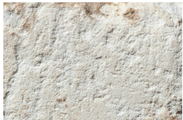
Abb. 23: Augusta Raurica. Weisser, feinkörniger und sehr homogener, kreidiger Kalk (Villigen-Formation, aus der Region Brugg-Baden AG?), mit der Inschrift 11 für Radoara. Breite des Bildausschnitts 3 cm.
