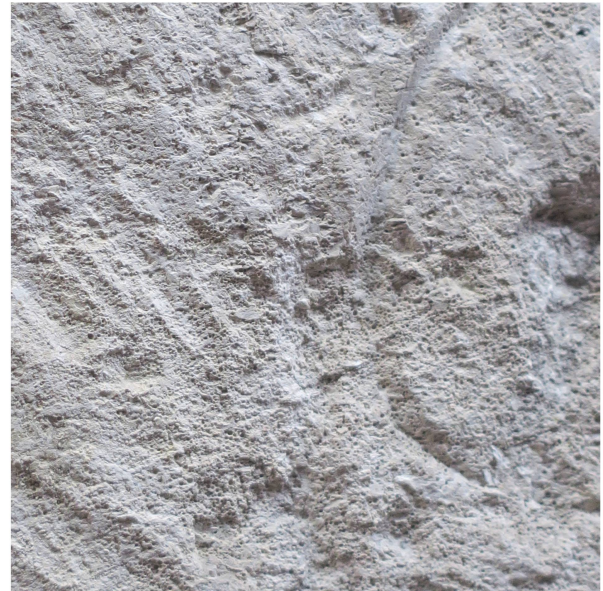
Abb. 12: Augusta Raurica. Kreidiger Korallenkalk (St.-Ursanne-Formation) mit der Inschrift 96. Detailansicht der weichen, kreidigen Oberfläche mit Ooiden. Breite des Bildausschnitts 8 cm.
