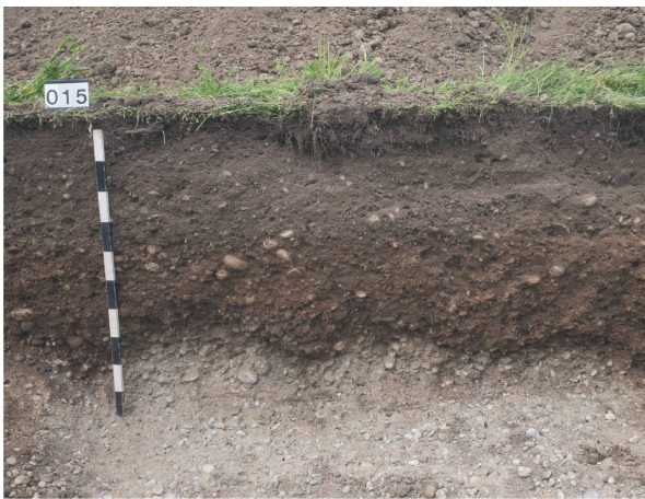
Abb. 35: Kaiseraugst AG, Sondierungen DSM (Grabung 2019.008). Blick von Osten auf die Schichten im Norden der Parzelle. Unter dem Humus liegt anstehender, verlehmter Kies, darunter unverwitterter Schotter. In weiten Teilen der Parzelle wurde ein vergleichbarer Schichtaufbau angetroffen.
