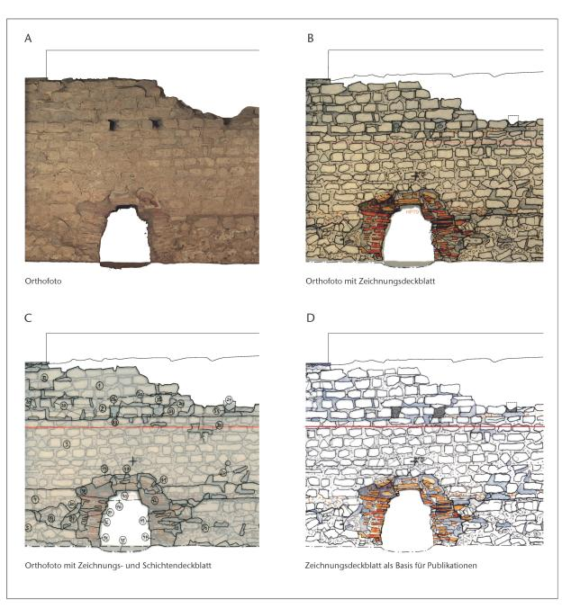
Abb. 41: Kaiseraugst AG, Dokumentation Rheinthermen (Grabung 2019.010). Zusammenstellung der verschiedenen digitalen und analogen Dokumentationsstufen.
