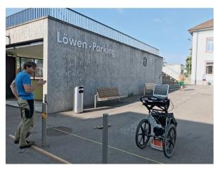
Abb. 43: Kaiseraugst AG, Prospektion Kaiseraugst (Prospektion 2019.011). Impression der geophysikalischen Prospektion im Sommer 2019. Manuel Buess bei der Prospektion des Schulhausplatzes mittels Georadar.
