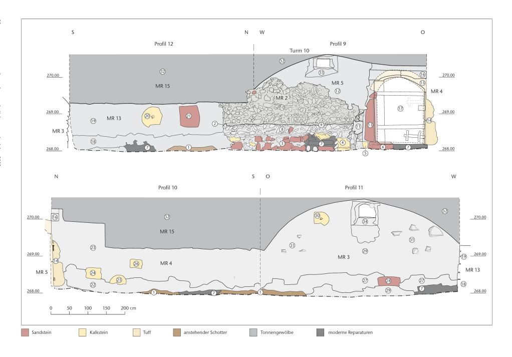
Abb. 16: Kaiseraugst AG, Bolingerhaus (Grabung 2019.003). Maueransichten des frühneuzeitlichen Gewölbekellers mit dem in die Nordwand integrierten Turm 10 sowie Teilen der in die Westwand integrierten Kastellmauer und tertiär verbauten römischen Spolien. M. 1:50.
