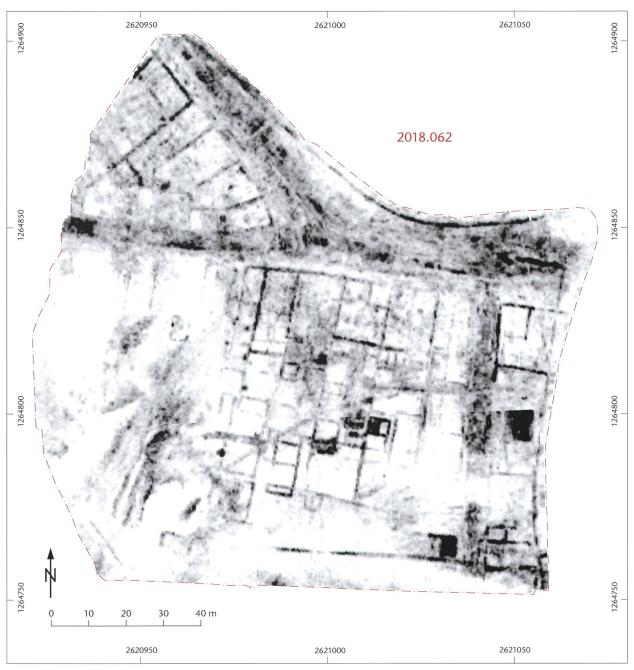
Abb. 13: Augst BL, Obermühle (Vorgang 2018.062). Tiefenscheibe (0,66 m) der Radarmessungen der Universität Bamberg mit den sich sehr detailliert abzeichnenden Befunden. M. 1:1000.
