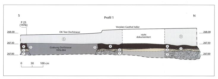
Abb. 57: Kaiseraugst AG, Wasserleitung Dorfstrasse und Tränkgasse (Grabung 2017.016). Schematische Umzeichnung des Westprofils P 1. M. 1:50.
