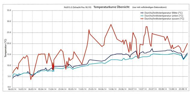
Abb. 13: Frick AG, Gänsacker 2013–2014 (Fic.013.02) – Schacht Pos.18.19. Synoptische Darstellung der aufgrund der jeweils am Vormittag und am Nachmittag erfassten Einzeldaten errechneten, durchschnittlichen Temperaturen im Aussenbereich (rot), im mittleren Teil von Schacht Pos.18.19 (dunkelblau) und auf der Sohle von Schacht Pos.18.19 (hellblau) in Grad Celsius.
