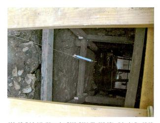
Abb. 12: Frick AG, Gänsacker 2013–2014 (Fic.013.02) – Schacht Pos.18.19. Die Temperaturmessungen im mittleren und unteren Teil von Schacht Pos.18.19 mithilfe von einfachen, an einer Schnur aufgehängten Thermometern.
