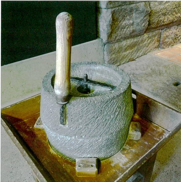
Abb. 16: Augst BL. Funktionsfähige Handmühle in der Brotbackstube von Augusta Raurica. Hier gut erkennbar sind die Achse mit dem Zentrierstift und der Fixierung sowie der am Läuferstein befestigte Griff.
