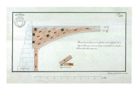
Abb. 22: Augst BL, Heilbad in der Grienmatt (Grabung 1803.062). Rekonstruktion der Gewölbedecke durch Aubert Parent im Manuskript von 1911.
