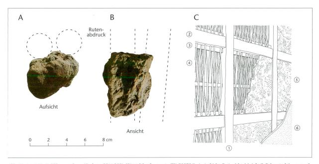
Abb. 12: Augst BL, Publikumsgrabung (Grabung 2014.058). Hüttenlehmfragmente (FK G00796). A: Aufsicht. B: Ansicht. M. 1:2. C: Rekonstruktionsversuch. 1: Ständerpfosten. 2: Querriegel. 3: Holzleiste. 4: Senkrechtes Rutengeflecht. 5: Lehm; Kernmaterial der Wand; Oberfläche aufgeraut zur besseren Haftung des Verputzes. 6: Deckputz.
