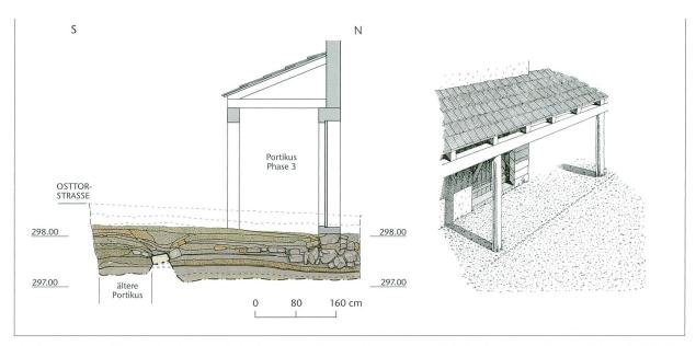
Abb. 11: Augst BL, Publikumsgrabung (Grabung 2014.058). Rekonstruktionsversuch, wie dieser Bereich in Bauphase 3 ausgesehen haben könnte. Links: Schnitt durch die Bodenhorizonte (Profil 2) und rekonstruierte Gebäudeaussenmauer mit Portikus-Konstruktion. M. 1:80. Rechts: perspektivische Ansicht.
