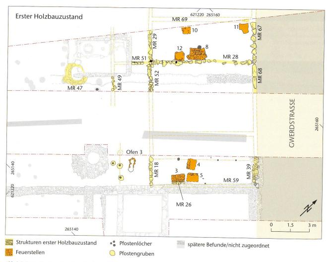
Abb. 8: Kaiseraugst AG, Auf der Wacht (Grabung 2012.001). Erster Holzbauzustand der Nordwestunterstadt an der Gwerdstrasse. Die Feuerstellen sind nummeriert. M. 1:150.
