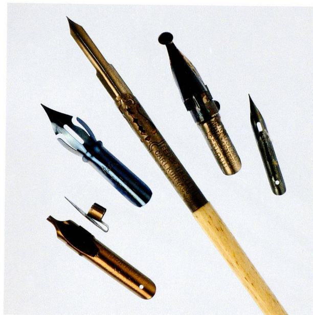
Abb. 19: Eine Auswahl moderner Schreib- und Zeichenfedern. Die Schreibfedern besitzen teilweise ein auf der Spitze aufgesetztes Blatt zur Regulierung des Tuschefflusses, erste und vierte Feder von links. M. 1:1.
