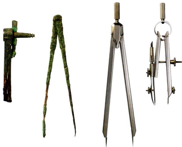
Abb. 50: Die Zirkel 283 und 286 aus Augusta Raurica neben modernen Zirkeln: Stechzirkel und Zirkel mit angeschraubter Ziehfeder. Die Schraube ersetzt den Feststellriegel. M. 1:2.
