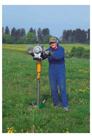
Abb. 5: Leichtes Kleimrammkern-Bohrgerät. Mit dem Einsatz eines solchen tragbaren Geräts entsteht kaum Flurschaden, wenn mitten in einem Acker eine Proben-Bohrung vorgenommen wird.
