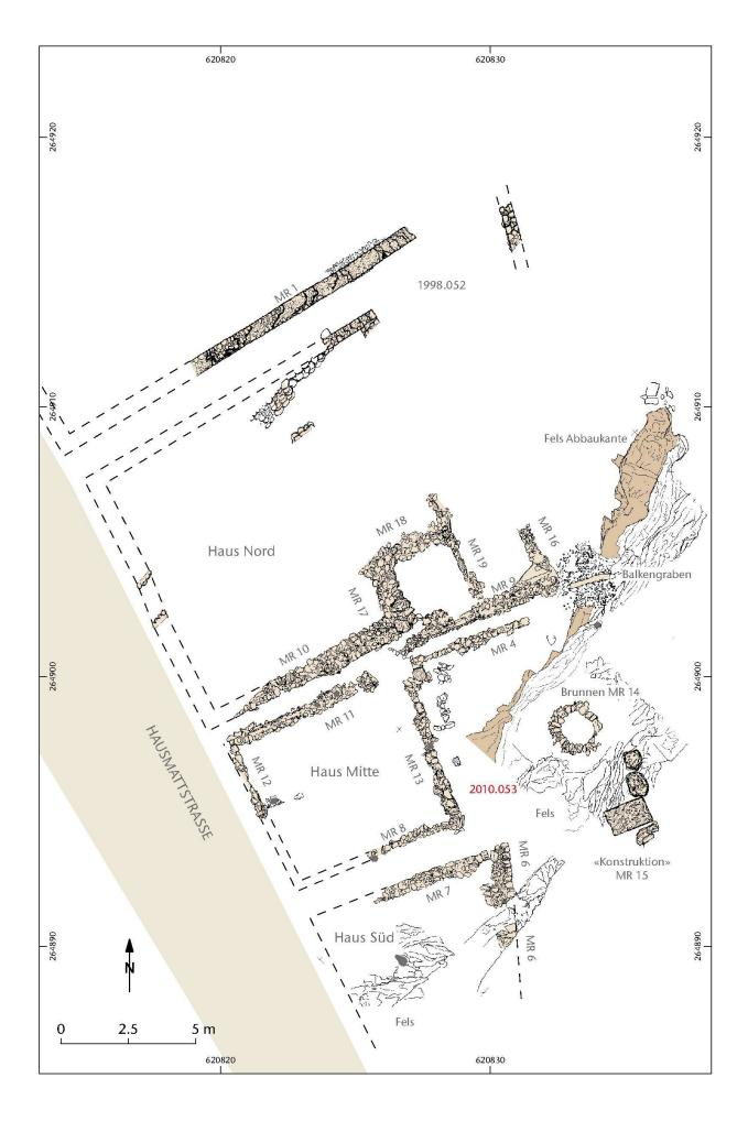
■ Abb. 16: Augst BL, Hausmatt (Grabung 2010.053). Römische Baureste in steingerechter Aufnahme, mit Gebäudenamen und Mauernummern. Eingetragen sind auch die Kanten des Steinbruchs, soweit sie nicht von Gebäudegrundrissen überdeckt sind. Pfostenlöcher sind schwarz ausgefüllt. M. 1:150.
