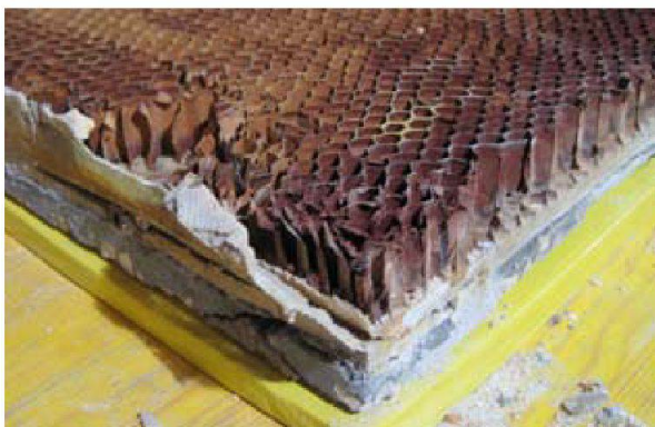
Abb. 68: Augst BL, Curia/Mosaikenausstellung. Oben: Die Trägerplatte des Mosaiks «Palazzo V», bestehend aus Waben, war ebenfalls verfault, statisch unsicher geworden und hat sich teilweise vom Mosaik gelöst. – Unten: Sogar das Wabengewebe aus dünnem Aluminium war völlig brüchig geworden.
