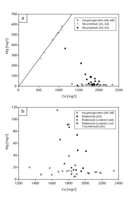
ben (Aufschlüsse A6–A8) unter 20 mg/l und damit unter ca. 1 Gew.-% liegt. Die Gesteine der Aufschlüsse A3–A5 haben einen variablen Mg-Gehalt, dieser ist im Mittel aber deutlich grösser als jener der Hauptrogensteinproben (Abb. 15,b).
