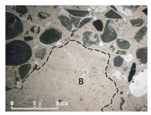
Abb. 7: Kalkspatz in einem Mörtel aus Augusta Raurica im Dünnschliff. A: Bindemittel mit Zuschlag, v. a. oolithischem Doggerkalk vermengt. – B: «Kalkspatz», zuschlagsfreie Zone.
