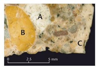
Abb. 27: Anschliff einer Putzprobe (Putzklasse: P1, Probe: PB01). A: Weisse Bindemittelkonkretion (Kalkspatz), frei von Zuschlag. B: Zuschlag (oolithischer Kalk). C: Mörtelschicht mit sehr wenig Zuschlag an der Putzoberfläche als Pigmentträger.
