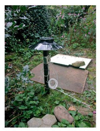
Abb. 5: Experimentelle Lösch- und Sumpfanordnung für Kalkmörtel mit Temperaturmesssonden des Autors in Gelterkinden/BL im Jahr 2003.
