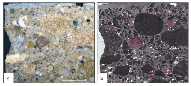
Abb. 28: a) REM-Probe (Anschliff) PB17 unter dem Binokular. – b) Gleiche Probe wie in a), Element Mapping mit REM (Rot = Silizium; Schwarz = Kalzium). Der Ausschnitt ist aus 36 Einzelbildern zusammengesetzt. Der aus Karbonat bestehende Zuschlag erscheint schwarz, das Bindemittel wegen der hohen Porosität heller. Grosse Poren und Löcher im Präparat sind weiss.
