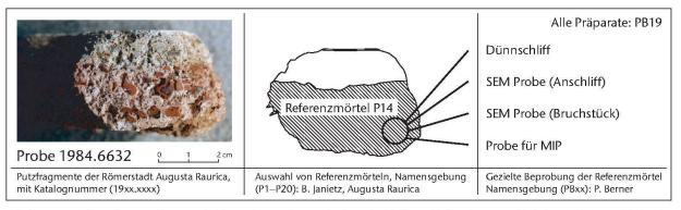
Abb. 25: Namensgebung der Putzproben am Beispiel von P14. Nur die rote «Ziegelmörtel»-Schicht wurde als Referenzmörtel definiert und darum gezielt beprobt.
