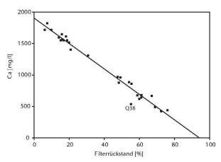
Abb. 22: Filterrückstand der in Säure gelösten Quartärproben gegen Ca-Gehalt in der Lösung (mit AAS gemessen).
