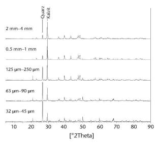
Abb. 23: Röntgendiffraktogramme von fünf Siebfraktionen der Probe Q01.
