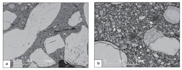
Abb. 30: Zwei Bindemitteltypen im Rasterelektronenmikroskop: a) Putzklasse P2: feinkörniges Bindemittel, praktisch frei von siltigem Zuschlag. Grosse Körner: hauptsächlich oolithischer Kalk. – b) Putzklasse P3: an siltigen Partikeln, vor allem Quarz, angereichertes Bindemittel. Grosse Körner: oolithischer Kalk.
