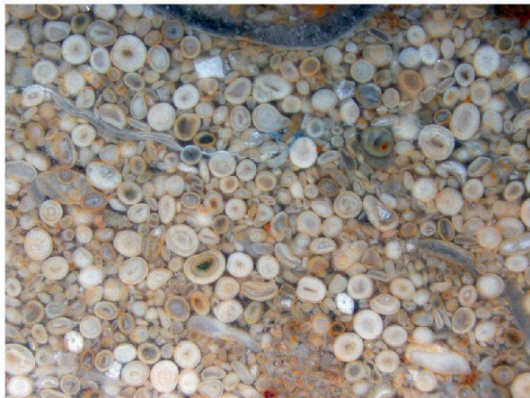
Abb. 11: Haupttrogenstein mit den typischen Ooiden. Oben natürlich gebrochen (Ausschnitt ca. 34 mm breit); unten angeschliffen und poliert (Ausschnitt ca. 13 mm breit).
