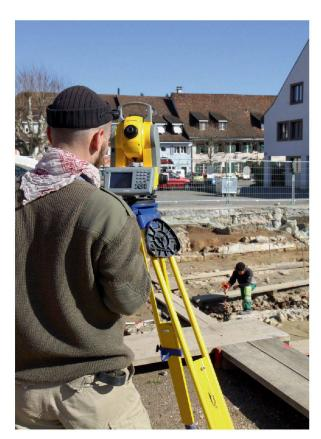
Abb. 7: Vermessung im Feld mittels Tachymeter. Die Ergebnisse der Messungen werden in für das Geografische Informationssystem lesbare Daten ausgegeben. Grabung Kaiseraugst-«Löwen», 2010.001.
