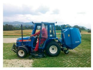
Abb. 112: Der neue Traktor des Technischen Dienstes von Augusta Raurica ist dank des grossen Aufnahme-Silos eine gute Hilfe beim Mähen und Laub-Aufnehmen der ausgedehnten Grünflächen in der Römerstadt.
