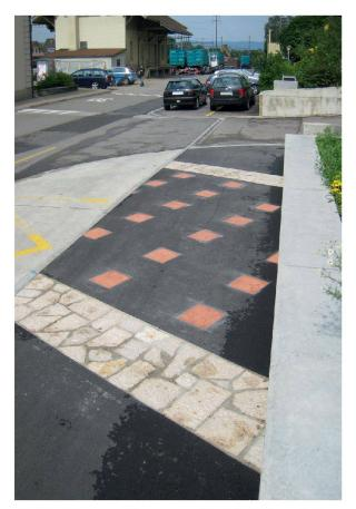
Abb. 109: «Unter unseren Füssen ...» – so soll bald die Markierung des Hypokaust-Raums für die Neuankommenden beim Bahnhof in Kaiseraugst beschriftet werden. Die Visualisierung wurde mit modernen frostfesten Platten erstellt: Kalksteine für die Mauerfluchten und rot gebrannte Tonplatten für die Hypokaust-Pfeilerchen.
