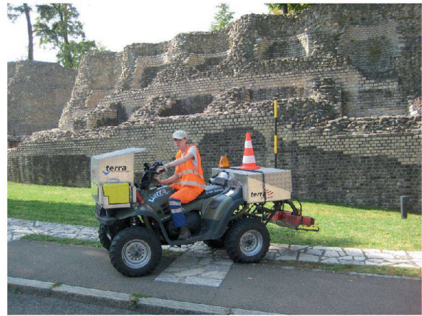
Abb. 73: Das römische Forum reicht im Südwesten bis unter den Belag der heutigen Giebenacherstrasse (im Bildvordergrund). Der Prospektions-Traktor der Firma Terra AG mit seinen beiden hinten montierten Georadar-Sendern steht hier allerdings auf der hellen Bodenmarkierung des Ersten Theaters.
