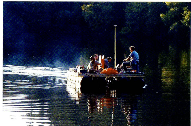
Abb. 8: Links: Entnahme von Sedimenten mithilfe von Bohrungen im Gebiet des trockengelegten Seewener Sees (Seewen/SO). Rechts: Seismische Messungen zur Kartierung der Sedimentablagerungen im Bergsee (Bad Säckingen/D).
