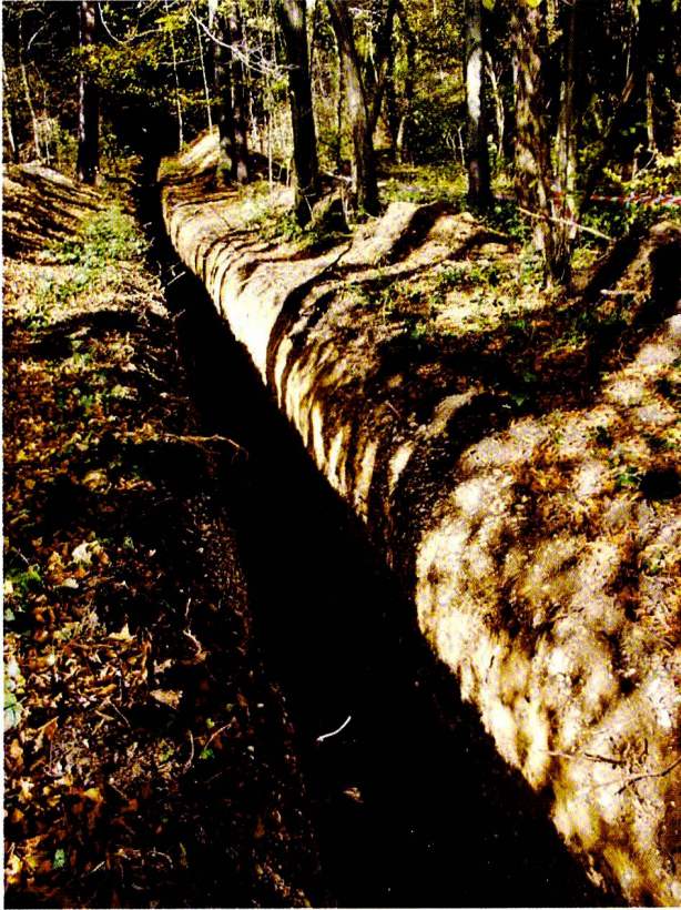
Abb. 6: Reinach, Fuss des Bruderholzes (= Abb. 11, Sondierung S2). 80 m lange Ausgrabung der Bruchfläche quer zur Richtung der Reinach-Verwerfung (Profil siehe Abb. 7).
