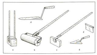
Abb. 20: Werkzeuge zur Herstellung von Terrazzoböden.
