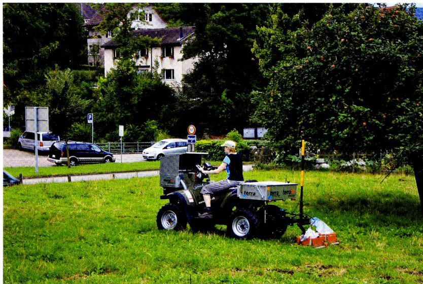
Abb. 65: Georadarprospektion durch die Firma Terra Vermessungen AG, Zürich, in Kaiseraugst-Auf der Wacht. Der Messtraktor führt eine geballte Ladung Hightech mit sich: zwei Laptops in einer dunklen Box vor dem Steuerrad, Messtechnik, Stromversorgung, Georadar-Antennen (hinten über dem Boden) und ein Peilgerät zum Tachymeter (gelb-schwarze Stange) zur laufenden Positionsmessung. Die Prospektion erfolgte im Hinblick auf eine grössere Überbauung und mögliche Forschungsgrabung.
