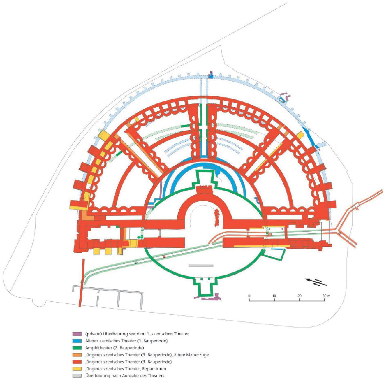
Abb. 10: Augst, Theatersanierung (Grabung 1992–2007.055). Grundrissplan des Augster Theaters (Überlagerung aller Phasen), Bauphasenplan der vortheaterzeitlichen Bebauung, der drei Theaterbauten und des spätrömischen Gebäudes im Nordwesten der Parzelle, Stand 2007. M. ca. 1:850.
