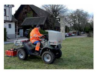
Abb. 39: Augst, Augusta Raurica. Der mit Hightech vollgepackte Kleintraktor der Firma Terra-Vermessungen aus Zürich wird in der geophysikalischen Prospektion von archäologischen Fundstätten eingesetzt. Das computerunterstützte Gefährt registriert seine Position laufend automatisch und kann sowohl Georadar-, Geoelektrik- wie auch Geomagnetikmessungen durchführen. Auf der «Rossweid» in der Augster Insula 10 wurden so viele Details der römischen Bebauungsstruktur ermittelt (2006.104).
