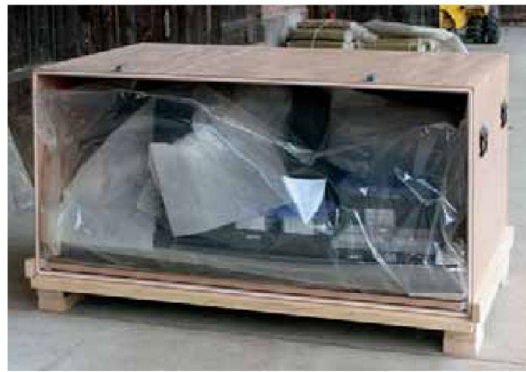
Abb. 45: Augst, Augusta Raurica, Theater-Nordwestecke, unter unterster Kulturschicht (Grabung 1987.054). Der mit Klimamittel versehene und in ESCAL TM -Folie eingeschweisste Baumstrunk einer Eiche in seiner neuen Verpackungskiste vor dem Schliessen der Seitenwand.
