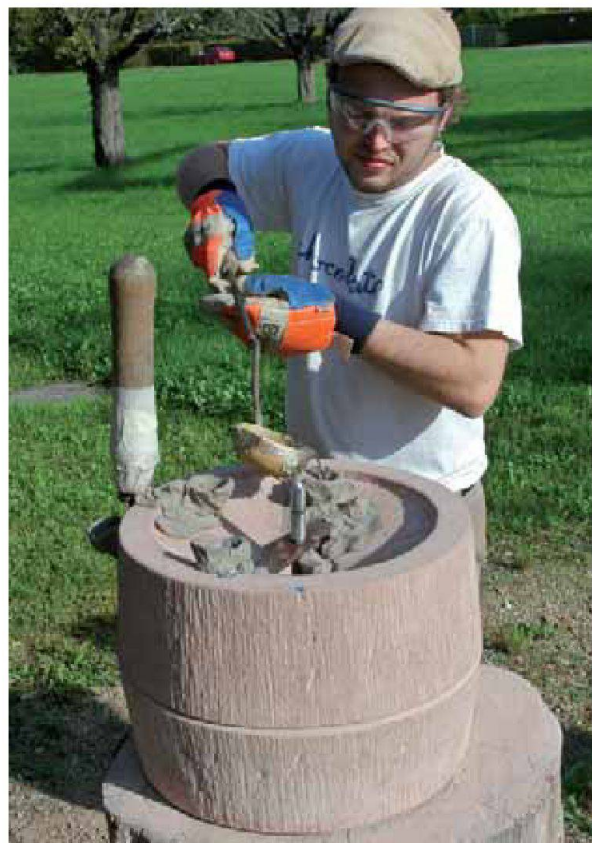
Abb. 7: Zivildienstinsatz für einen guten Zweck: Mario Völlmin ist gelernter Steinmetz und hat bei seinem Einsatz in Augusta Raurica u. a. eine römische Steinmühle kopiert. Im Bild vergiesst der Steinmetz in antiker Technik die eiserne Achsführung mit flüssigem Blei im Stein des «Oberläufers» der Handmühle.
