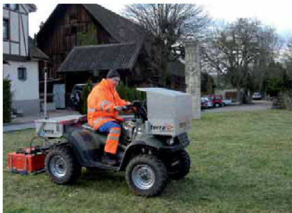
Abb. 39: Augst, Augusta Raurica. Der mit Hightech vollgepackte Kleintraktor der Firma Tema-Vermessungen aus Zürich wird in der geophysikalischen Prospektion von archäologischen Fundstätten eingesetzt. Das computerunterstützte Gefährt registriert seine Position laufend automatisch und kann sowohl Georadar-, Geoelektrik- wie auch Geomagnetikmessungen durchführen. Auf der «Rossweid» in der Augster Insula 10 wurden so viele Details der römischen Bebauungsstruktur ermittelt (2006.104).
