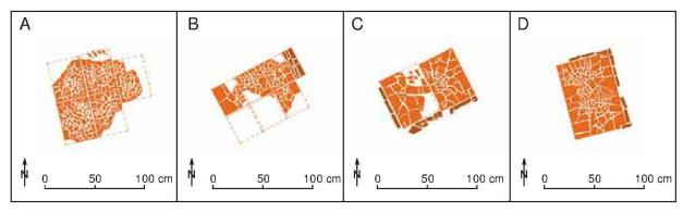
Abb. 12: Augst BL, Publikumsgrabung (Grabung 2006.058). Feuerstellen. Die Konstruktionen A–C befanden sich im Raum mit dem Holzgestell. A, C und D wurden mit umgedrehten Leistenziegeln konstruiert, bei Feuerstelle B wurden Hypokaustplatten verwendet. M. 1:40.
