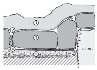
Abb. 48: Augst, Theatersanierung (Grabung 2005.055). Ziegelmosaikboden im nordwestlichen Theater-Vorgelände. Aufbau der provisorischen Wintersicherung, unmassstäbliche Skizze.
