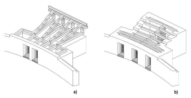
Abb. 5: Augst, Theatersanierung (Grabung 1998.055). Grundlagen zur Erarbeitung eines Auswertungskonzepts. Rekonstruktionsversuch der beiden Bauphasen des Ostcarcers des Amphitheaters; a) ältere Phase mit Unterkonstruktion für eine hölzerne cavea; b) jüngere Phase mit drei Verbindungspforten zur Arena und massiver Holzbalkenunterlage für die Buntsandstein-Sitzstufen der steinernen cavea.
