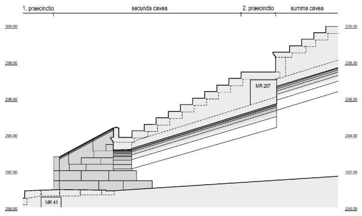
Abb. 13: Augst, Theatersanierung (Grabung 2001.055). Grundlagen zur Erarbeitung eines Auswertungskonzepts. Rekonstruierter Schnitt durch den caveaseitigen Mündungsbereich des Südost-Vomitoriums und die Sitzstufen des zweiten Rangs (secunda cavea) des jüngeren szenischen Theaters. Im Bereich des oberen Sitzstufenumgangs (zweite praecinctio) ist das Tuffsteingewölbe der Vomitoriumsüberwölbung nachweislich um 50–60 cm nach oben gesprungen.
