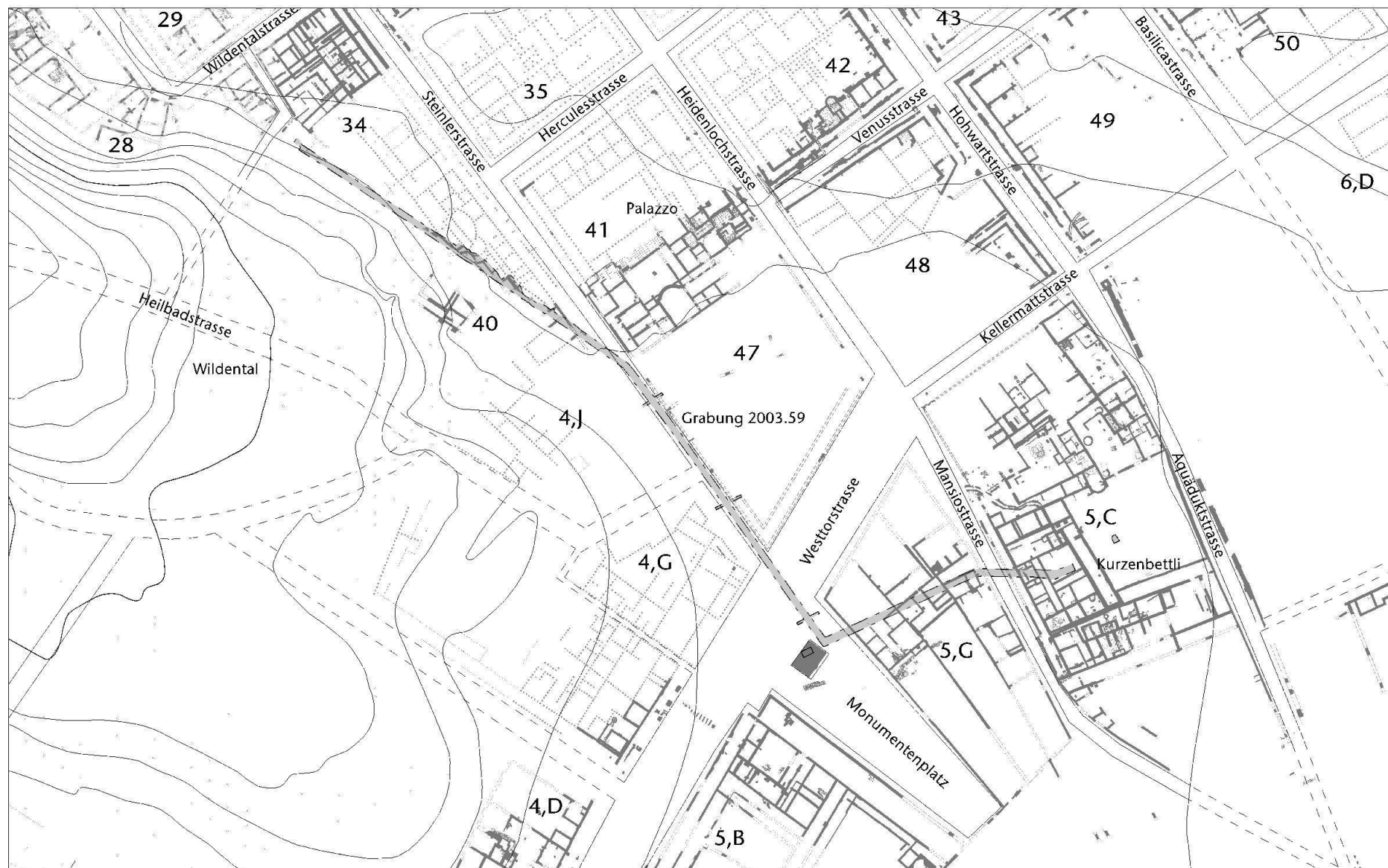
Abb. 33: Augst BL, Leitungsgaben Kellermatt (Grabung 2003.59). Verlauf des Grabens (hellgrau) mit der Lage der erwähnten Areale der römischen Stadt. Die dicht gesetzten Punktreihen bezeichnen die mit Hilfe des Bodenradars festgestellten Mauerzüge, lose Punktreihen Luftbildbefunde. M. 1:1500.
