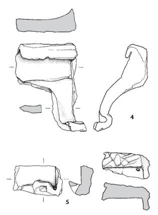
Abb. 7: Augst, Augusta Raurica. Die analysierten Verbleiungen von eisernen Bauklammern, Kat. 4 und 5 (s. Fotos Abb. 6). M. 1:2.
