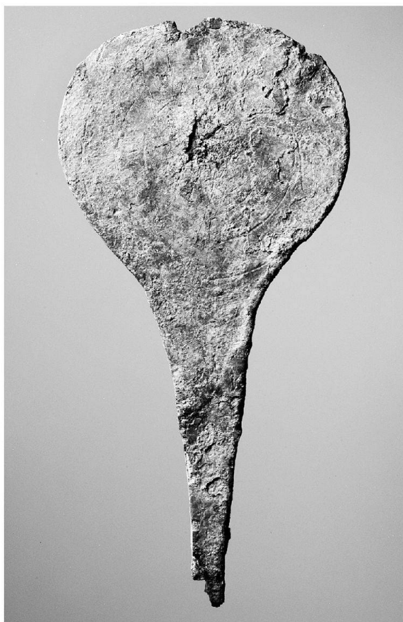
Abb. 10: Augst, Augusta Raurica. Das analysierte Bleistück mit kreisförmig verbreiterem Ende. Man beachte die beidseitig mit dem Zirkel eingerissenen konzentrischen Linien. Kat. 10. M. 1:1.
