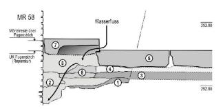
Abb. 7: Augst, Theatersanierung (Grabung 2003.55). Peripheriemauer (MR 58) Keil 3. Mögliche Phasenabfolge (Phasen 1–3) für den mutmasslichen, an die Peripheriemauer 58 anschliessenden Sandstein-Plattenbelag. M. 1:40.
