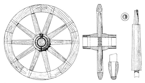
Abb. 7: Das Segmentfelgenrad vom Kastell Zugmantel zeigt alle Merkmale römischer Speichenräder: Symmetrische Naben mit konischer Bohrung, gedrechselte, konisch zulaufende Speichen, hohe Felgen und eine schmale Lauffläche mit einem halbrund profilierten Eisenreifen.
