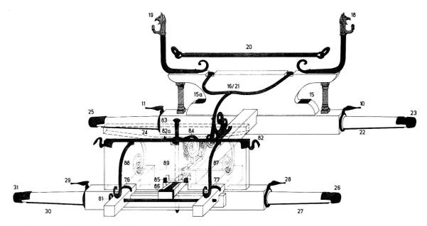
Abb. 9: Der Wagen aus Kozármisleny. Isometrische Ansicht des Fahrgestells.
