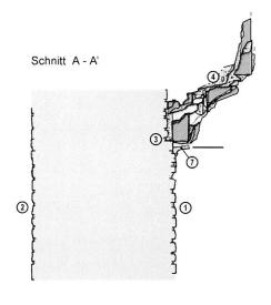
Abb. 6: Augst, Theatersanierung (Grabung 2002.55). Blendbogen der südlichen Eingangshalle. Ansicht und Schnitt des erhaltenen Baubefunds. M. 1:30.
