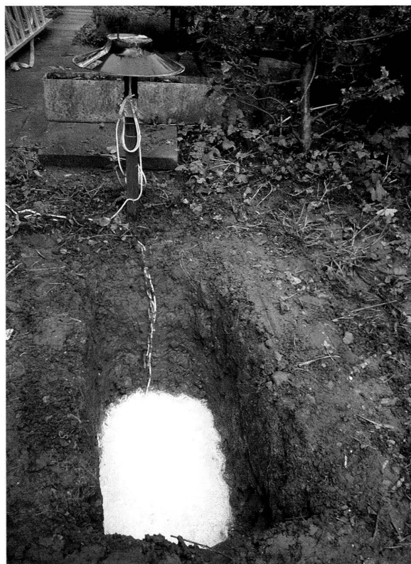
Abb. 31: Experimentelle Archäologie im Rahmen des Projekts «römische Kalkmörtel»: Geöffnete Kalksumpfgarbe im lehmigen Boden (um den Kalk gegen Witterungseinflüsse zu schützen, ist die Grube normalerweise mit Brettern und Erde gedeckt). Der Sumpfkalk wurde frisch mit Wasser überdeckt und umgerührt. Feuchtigkeit und Temperatur werden an verschiedenen Stellen in der Luft, in der Grube, im Boden und im Kalk gemessen und mit einem Computer aufgezeichnet. Das Produkt, experimentell hergestellter Sumpfkalk, soll später mit antiken Mörteln analytisch verglichen werden.
