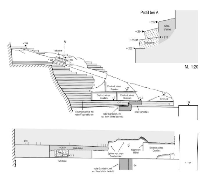
Abb. 3: Augst, Theater. Südwange des Südost-Vomitoriums, Ansicht, Aufsicht und Detailschnitt. Umzeichnung und Beschriftung nach der Bauaufnahme von Karl Stehlin aus dem Jahr 1927. Die Kalksteinlagen des Mauerwerks sind schematisch wiedergegeben. M. 1:60 (Detailschmitt 1:20).
