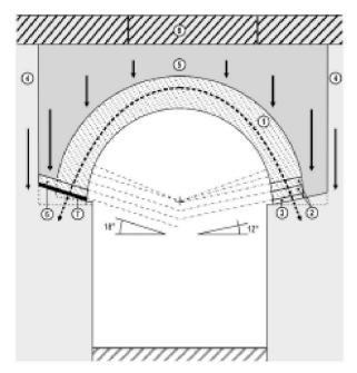
Abb. 12: Augst, Theater. Schematischer Querschmitt durch das Gewölbe des Südost-Vomitoriums. Die gestrichelten Pfeile zeigen den Kräfteverlauf innerhalb des Gewölbebogens auf, die schwarzen Pfeile markieren die Auflast über dem Gewölberücken. M. 1:50.
