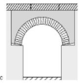
Abb. 13: Augst, Theater. Südost-Vomitorium, Bauabfolge bei der Errichtung der Vomitoriumsüberwölbung. Ohne Massstab.
