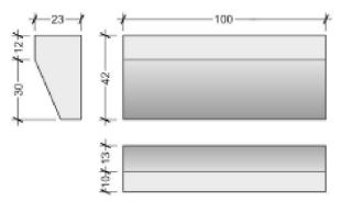
Abb. 15: Augst, Theater. So genamtes «nördliches Treppenhaus»; mutmasslicher Kämpfer des Werksteinbogens im Mündungsbereich zur cavea (Buntsandstein). Von Isidoro Pellegrini 1938 in sekundär verbauter Lage gefunden. Umzeichnung nach der Aufnahme von Isidoro Pellegrini. M. 1:20.
