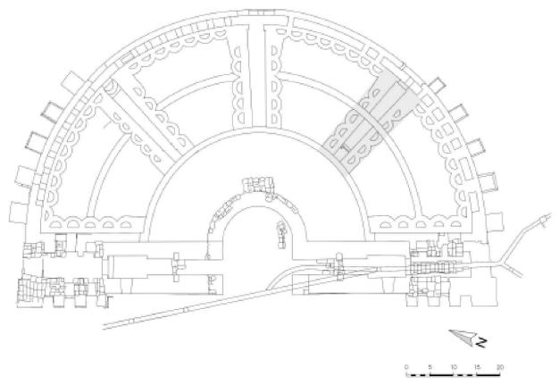
Abb. 1: Augst, Theater. Grundrissplan (jüngste Bauphase) mit Lage des Südost-Vomitoriums (hellgrau). M. ca. 1:700.
