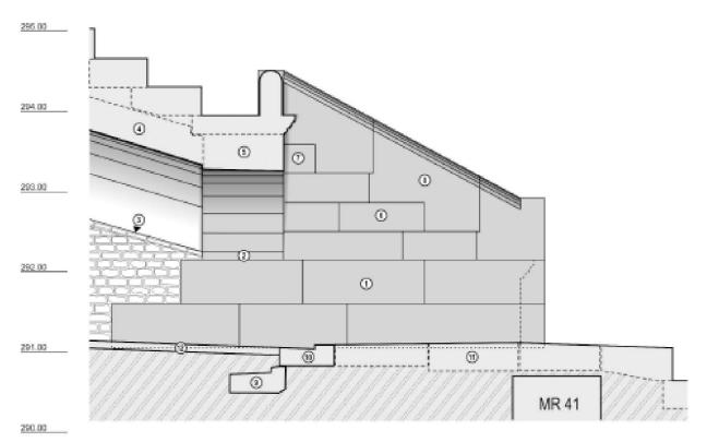
Abb. 17: Augst, Theater. Südost-Vomitorium, Ansicht an die rekonstruierte Südwange im Mündungsbereich zur cavea und Schnitt im Bereich der Mittelachse des Vomitoriums. M. 1:50.
