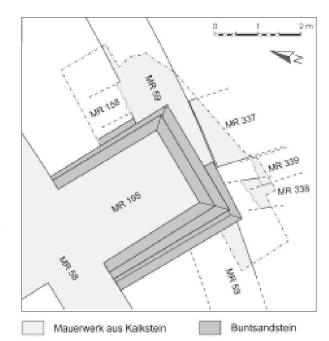
Abb. 30: Augst, Theatersanierung (Grabung 2001.55). Umfassung jüngeres szenisches Theater, Stützpfeiler MR 195/Umfassung älteres szenisches Theater MR 59. Orientierungsplan zum Mauerbefund in den Feldern 158, 167 und 168. M. 1:85.
