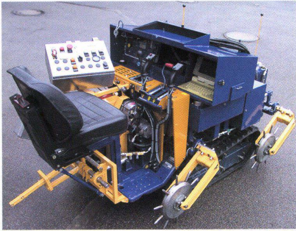
Abb. 2: In der Kantonsarchäologie Zürich aufgebautes Raupenfahrzeug für die effiziente und gleichzeitige Messung mit der Elektrik (die Eisenräder mit Spitzen dienen als Elektroden) und dem Bodenradar (die Antenne wird an der kurzen Stange hinten am Fahrzeug befestigt).
