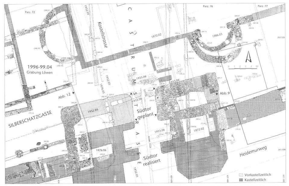
Abb. 8: Kaiseraugst AG, «Löwen»-Areal, Heidemurweg/Kastellstrasse (Grabung 1999.04). Planausschnitt des Südtors des Castrum Rauracense mit ursprünglich grösserem Fundament und reduziert ausgeführtem Grundriss mit Nordflanke im Ostteil. M. 1:200.
