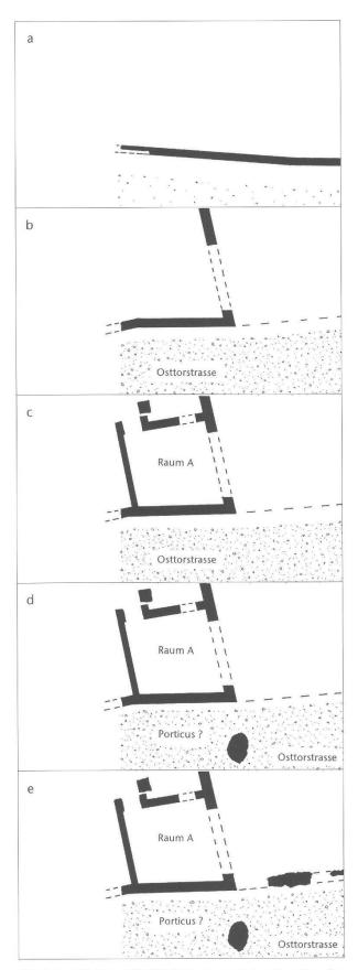
Abb. 9: Augst (Grabung 1999.58). Relativchronologischer Phasenplan. Zu a bis e vgl. Text. o. M.
