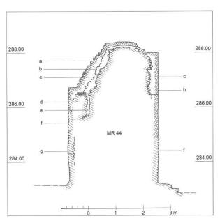
Abb. 33: Augst, Theatersanierung (Grabung 1998.55). Schäden an der äusseren Bühnenmauer 44. Schematischer Querschnitt.
