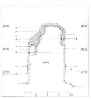
Abb. 40: Augst, Theatersanierung (Grabung 1998.55). Südaditus. Sanierung der äusseren Bühnenmauer 44. Schematischer Querschnitt mit den restauratorischen Eingriffen.
