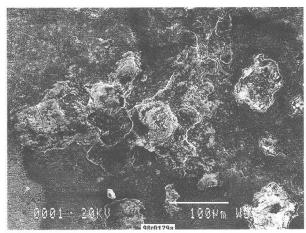
Abb. 4: REM-Aufnahme des Pferdegeschirranhängers (vgl. Abb 3). Deutlich erkennbar die Auflagerungen eines zweiten Metalls auf der (versilberten) ursprünglichen Oberfläche.
