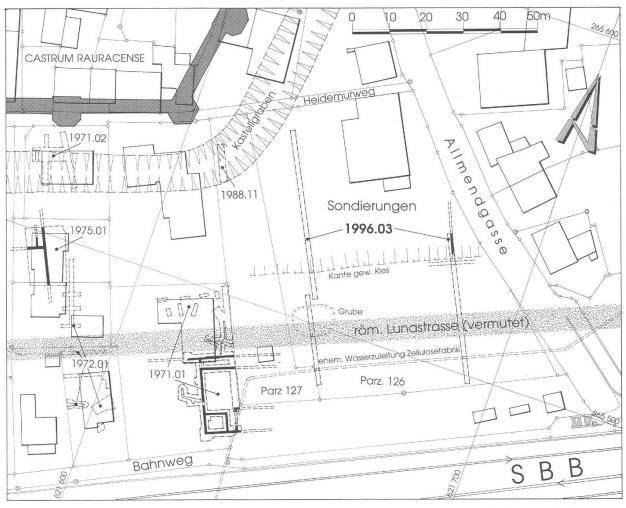
Kaiseraugst, Allmendgasse (Grabung 1996.03). Lage der Sondierschnitte mit Spuren(?) der Lunastrasse im Westen und Mauerfundament im Osten. M. 1:1000.
