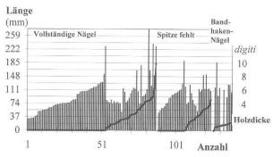
Abb. 38 Augst, Tempel Sichelen 2. Nägel aus Feld 24. Verhältnis von der Gesamtlänge (= Balkenlänge im Diagramm) zur Distanz zwischen Nagelkopf und erster Biegung des Schaftes (= Punkte). Die Linie entspricht in etwa der «Holzdicke». 1–87: vollständige Scheibenkopfnägel, 89–124: nur die vorderste Spitze fehlt, 127–139: Bandhaken-Nägel. Skalierung: digiti.
