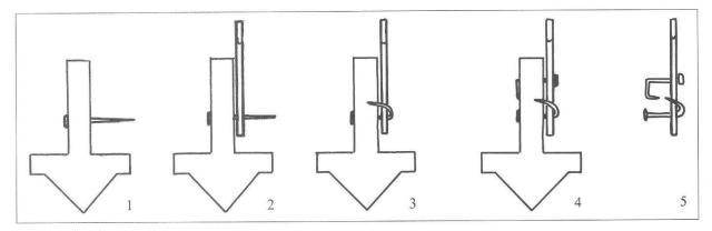
Abb. 33 Augst, Curia und Tempel auf dem Schönbühl. Rekonstruktionsvorschlag zur Klärung der Frage nach den wechselseitig eingeschlagenen Nägeln der Bandhaken Typ 2. M. etwa 1:5.
