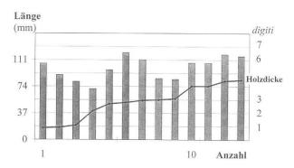
Abb. 31 Augst, Tempel Sichelen 2. Vollständige Splinte Typ 2: Verhältnis von der Gesamtlänge (= Balkenhöhe im Diagramm) zur Distanz zwischen Schulter (X-Achse) und erster Biegung der Schenkel (= Linie: sie entspricht etwa der «Holzdicke»). Skalierung: digiti.
