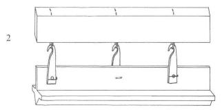
Abb. 42 Augst, Tempel Sichelen 2. Vorschlag für die Befestigung einer hölzernen Deckenverkleidung mit Hilfe von eisernen *Bandhaken Typ 1* und Splinten (die Abstände zwischen den einzelnen Haken sind verkürzt dargestellt; vgl. Text). M. 1:5.
