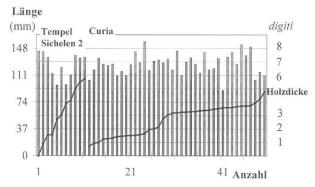
Abb. 30 Augst, Curia und Tempel Sichelen 2. Vollständige Splinte Typ 1.2.: Verhältnis von der Gesamtlänge (= Balkenhöhe im Diagramm) zur Distanz zwischen Schulter (X-Achse) und erster Biegung der Schenkel (= Linie: sie entspricht etwa der «Holzdicke»). Skalierung: digiti.
