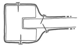
Abb. 52 Ein Beispiel für die ehemalige Verwendung vom Bandfragment Taf. 8,82 (Querschnitt). Zwei vernutete Hölzer (z.B. ein Pfosten und ein Brett) werden durch ein sie umfassendes, angenageltes Band zusammengehalten, M. 1:3.
