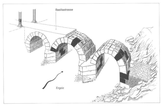
Abb. 13 Augst BL, «Im Rumpel» (Grabung 1995.64). Rekonstruktionszeichnung der Ergolzbrücke. Schwarz: hypothetisch eingezeichnete Quader und Keilsteine, die in Zweitverwendung aus der 1995 aufgedeckten Uferverbauung der Ergolz stammen.
