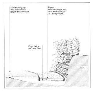
Abb. 9 Augst BL, «Im Rumpel» (Grabung 1995.64). Profil durch die Uferverbauung, die Ergolz und die Steilböschung aus Fels.
