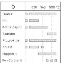
Abb. 15 Veränderung des Mineralbestandes eines illitischen Rohstoffes mit zunehmender Brenntemperatur (Heimann et al. 1980).
