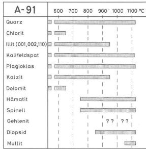
Abb. 12 Veränderung des Mineralbestandes zweier Rohtone mit zunehmender Brenntemperatur (oxidierende Bedingungen, 1 h Haltezeit bei Maximaltemperatur). A-91 (Jornet 1982), Ro 4 (Czysz et al. 1984).
