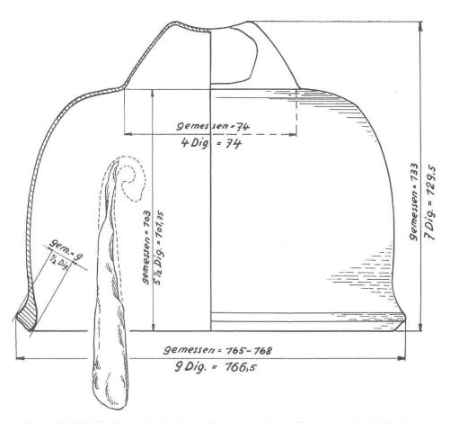
Abb. 4 Augst-Insula 24 (1945). Querschnitt durch die gut erhaltene Glocke (nach A. Mutz) und zugehöriger Klöppel aus Eisen. M. 1:2.
