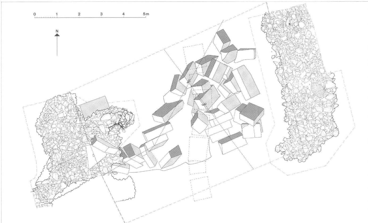
Abb. 3 Augst-«Bötme» (Grabung 1969.52). Steingerechter Plan: in der Mitte die eingestürzten Bogenquader. Westlich und östlich davon befinden sich die kleinteiligen Reste der Bogenwiderlager. M. 1:100.
